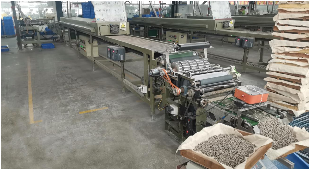
真空挤条机+切条机+皮带干燥线+自动切粒机总装图
